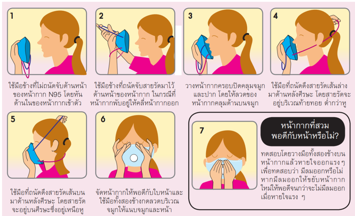
รูป 3.3 วิธีการสวมใส่และการทดสอบความแนบสนิท (Fit check) ของหน้ากากกรองอนุภาค
